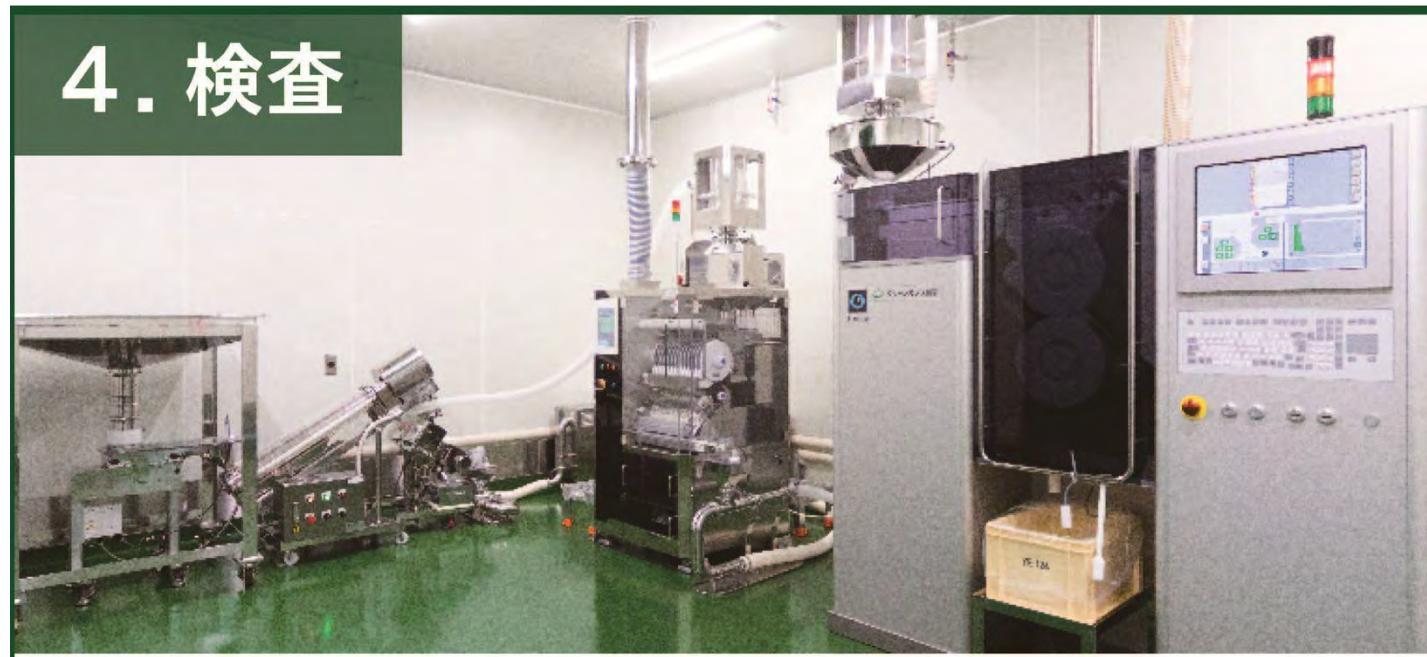
金属検知・質量選別・外観検査機
